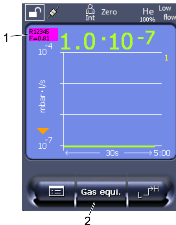
Рис. 3: Измерительный экран с индикацией эквивалентной интенсивности утечки и настроенной кнопкой избранного
